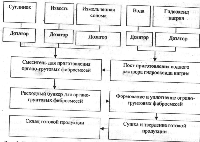
Рис.6. Технологическая схема изготовления органогрунтовых фиброблоков.
