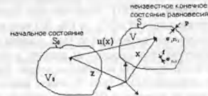
Рис.2. Иллюстрация задачи классического подхода. К начальному состоянию (V_0, S_0) прикладываются внешние силы и тело, двигаясь и деформируясь, переходит в конечное состояние (V, S) , где обретает равновесие.
