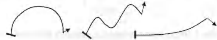
Рис. 4. Формы равновесия стальной линейки (левый конец зашпелен, а на правом имеется внешняя сила p).
