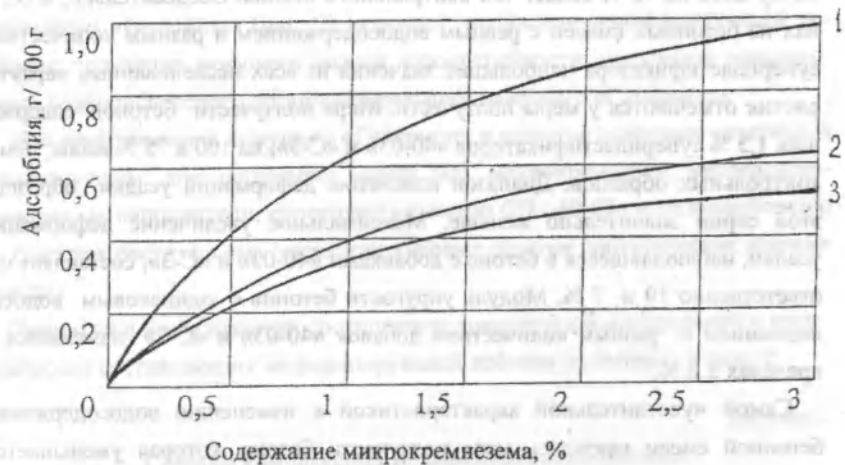
Рис. 1 Адсорбция суперпластификатора «40-03» на вяжущем, содержащем разное количество микрокремнезема 1 - без микрокремнезема; 2 - с 10 % микрокремнезема; 3 - с 20 % микрокремнезема
