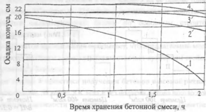
Рис. 5 Изменение пластичности бетонных смесей во времени
