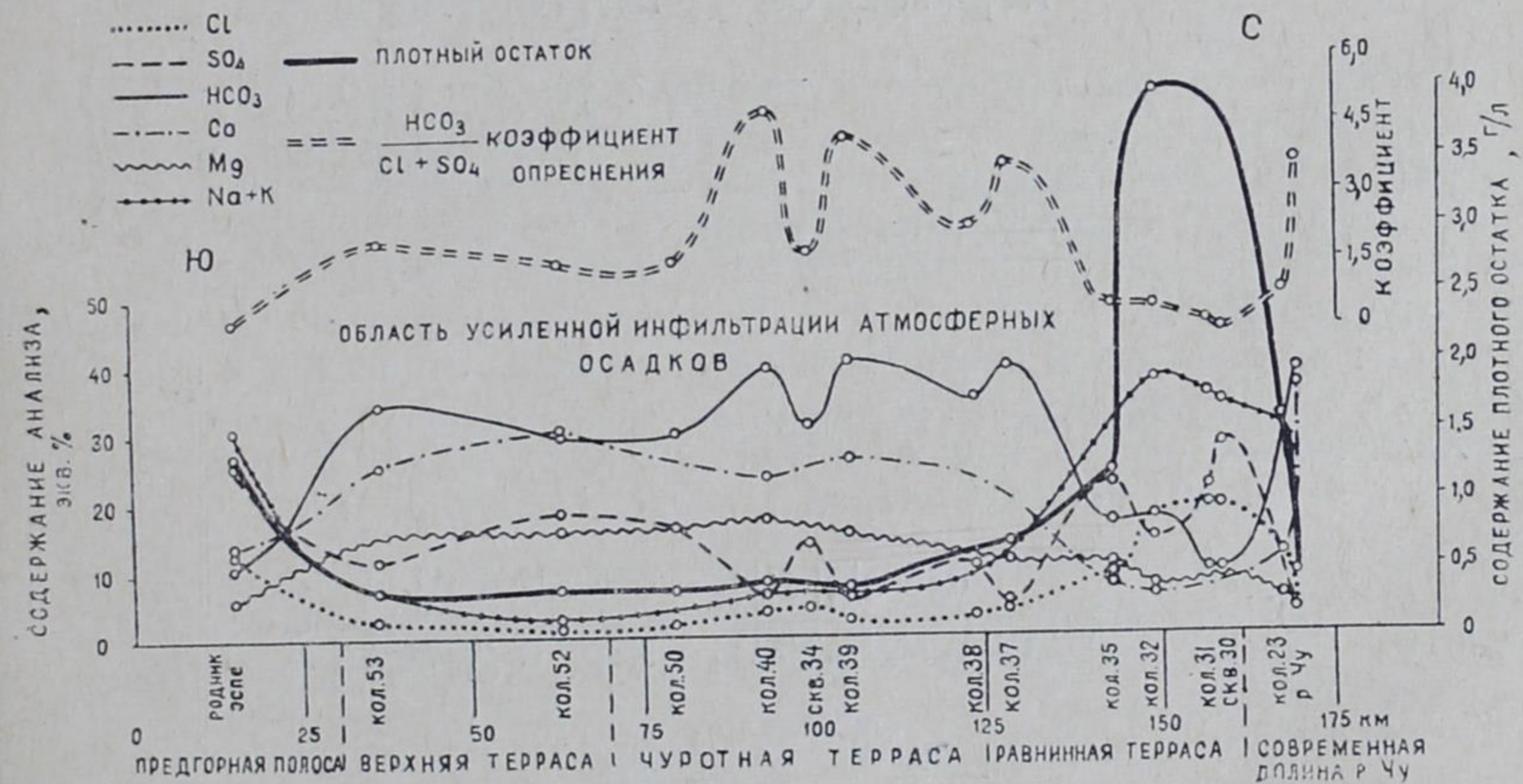
Рис. 69. Изменение химического состава грунтовых вод песков Муюнкум (по линии ст. Малдыбай — с. Фурманово).
