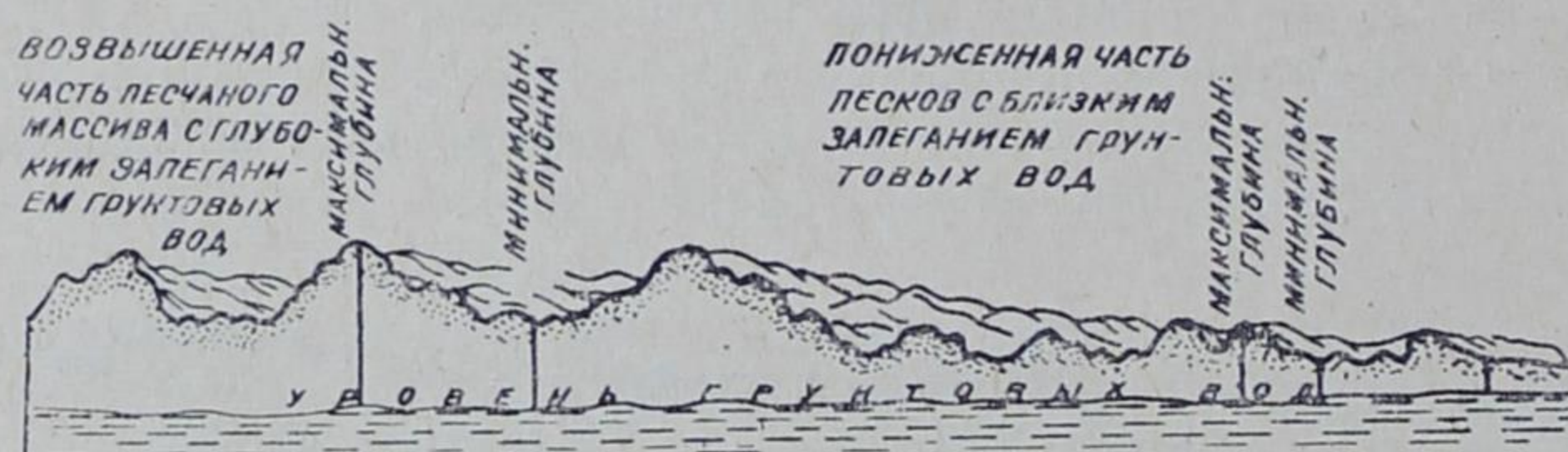
Рис. 67. Схема взаимоотношения рельефа и уровня грунтовых вод в песчаных массивах.
