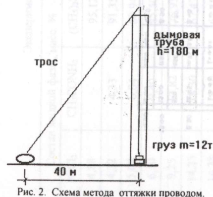
Рис. 2. Схема метода оттяжки проводом.
