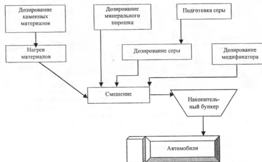
Общая схема технологической линии приготовления серного бетона
