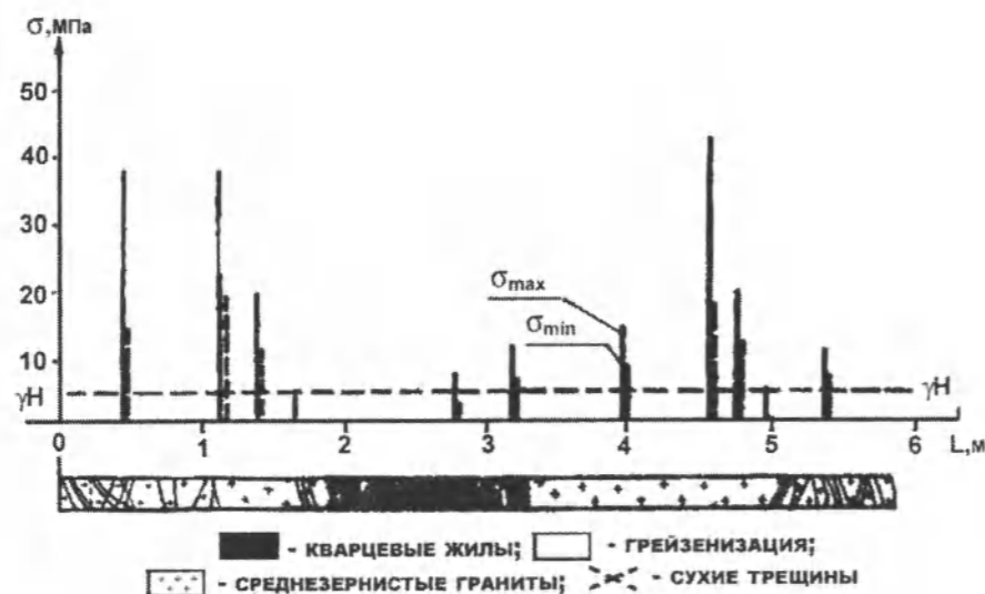
Рис. 7. Результаты измерения напряжений методом разгрузки по горизонтальной скважине на месторождении Восточный Коунрад на глубине 220 м (Центральный Казахстан) [3].
