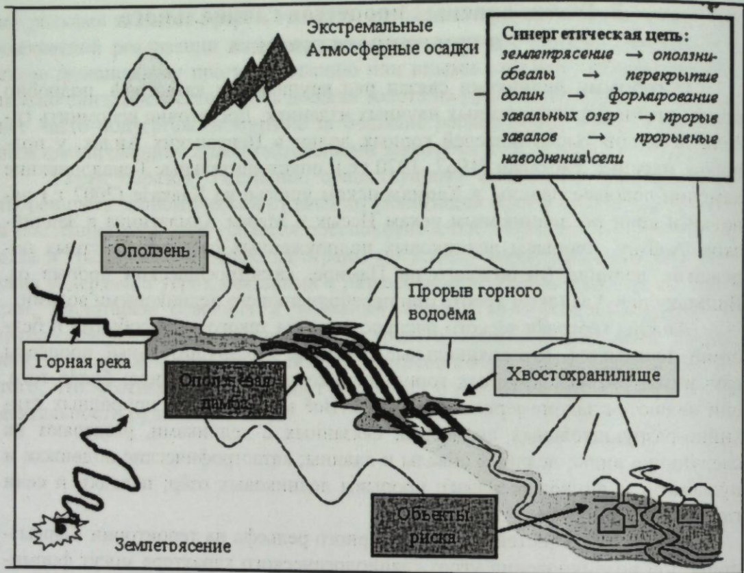
Рис. 50. Многоступенчатые опасные процессы в высокогорных районах
