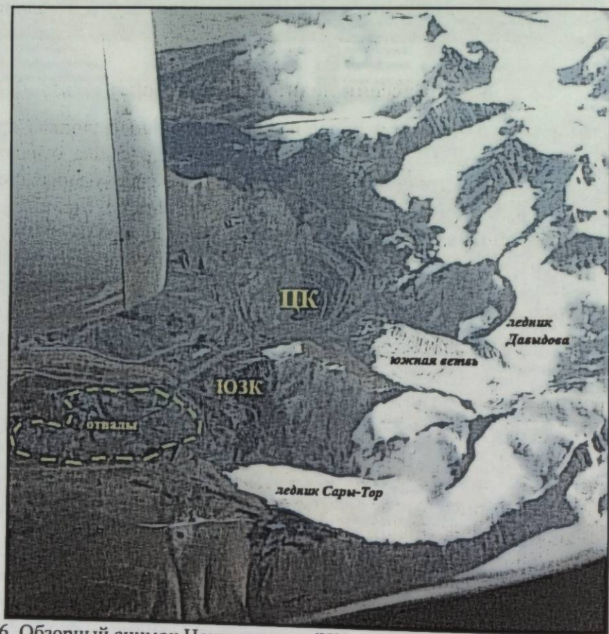
Рис. 36. Обзорный снимок Центрального (ЦК) и Юго-Западного карьеров (ЮЗК) рудника Кумтор, ледников Давыдова и Сары-Тор с высоты птичьего полёта: хорошо видны оползающие отвалы на правом борту долины р. Кичи-Сарытор, под ледником Сарытор виден водоём Юго-Западного карьера, в который перекачиваются загрязнённые воды из Центрального карьера [20].
