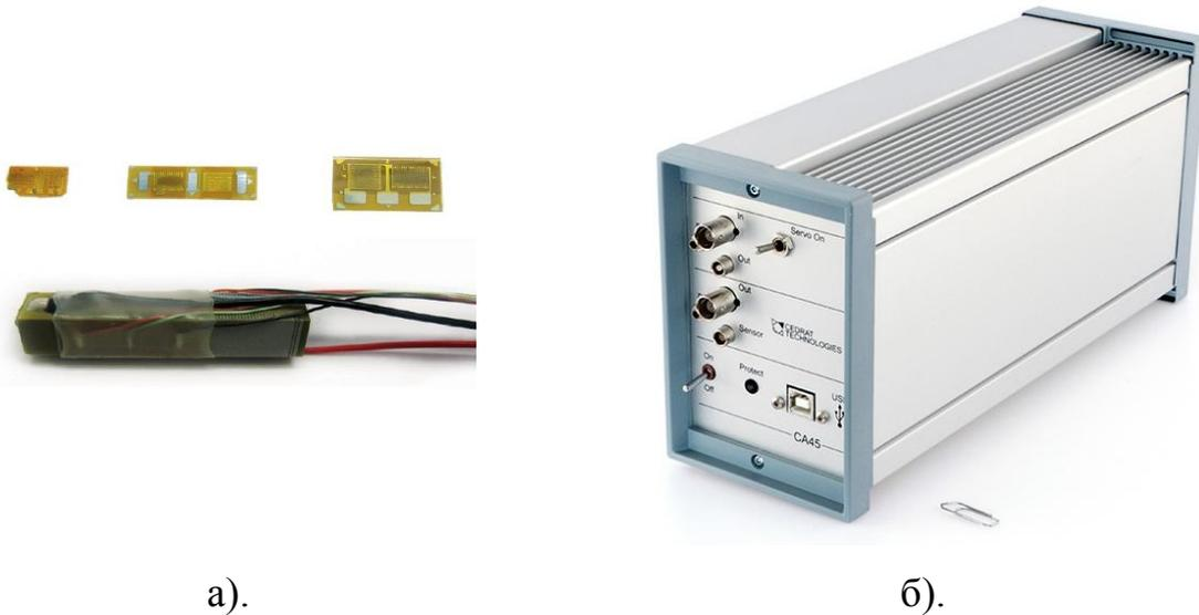
Рис.2. Пьезостек с тензодатчиком (а), преобразователь CA45-UC45-SG (б)
