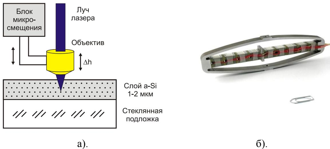
Рис.1. Запись внутри слоя a-Si (а), пьезоактюатор серии APA (б)
