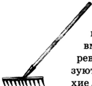
Грабли делаются из тонких металлических или деревянных прутьев, соединённых вместе и прикреплённых к деревянной ручке. Грабли используют, чтобы осенью собирать сухие листья в кучу.
