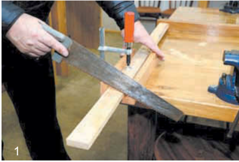
Рис. 68. 1- пиление с упором; 2 – пиление в стусле
