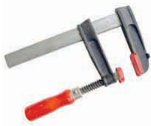
Рис. 72. 1. Выпиливание лобзиком. 2. Струбцина
