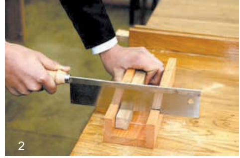
Рис. 68. 1- пиление с упором; 2 – пиление в стусле
