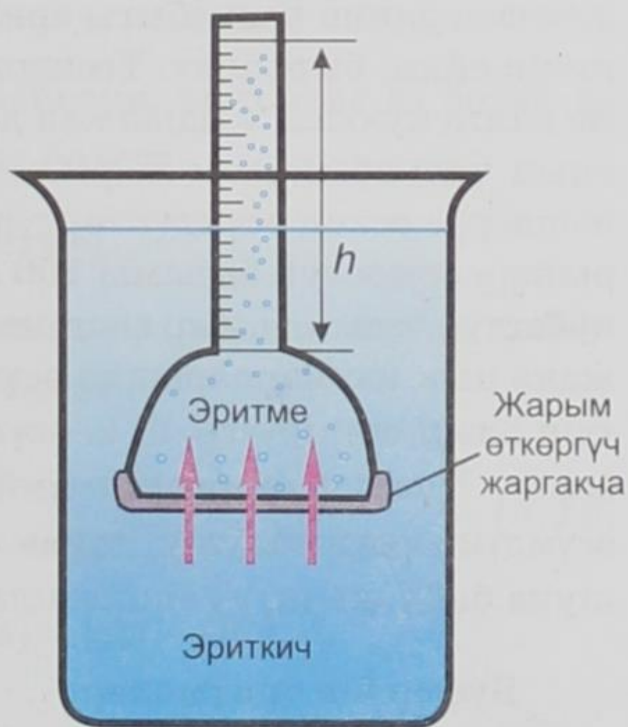
4.6-сүрөт. Осмометрдин иштөө принциби.
