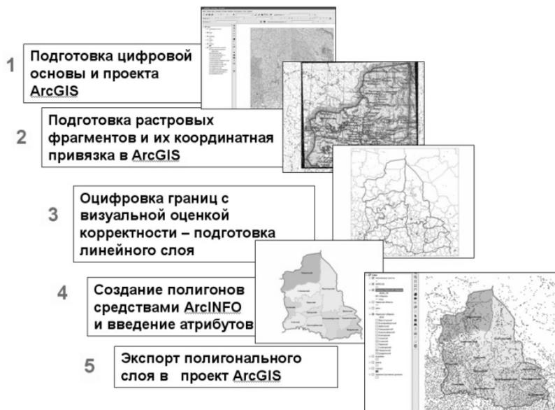
**Рис. 1. Технологическая схема создания электронной карты**
