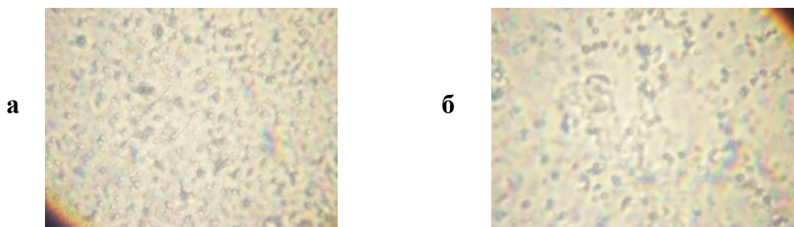
Рис.12. Дисперсность частиц карбидов вольфрама (а) и титана (б), выделенных из водной суспензии, увел.1000 кратное.
