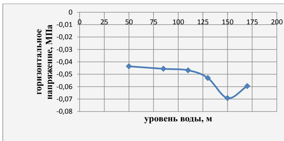
Рис.7.Зависимость изменения горизонтальных сжимающих напряжений в массиве однородного склона от уровня воды в водохранилище
