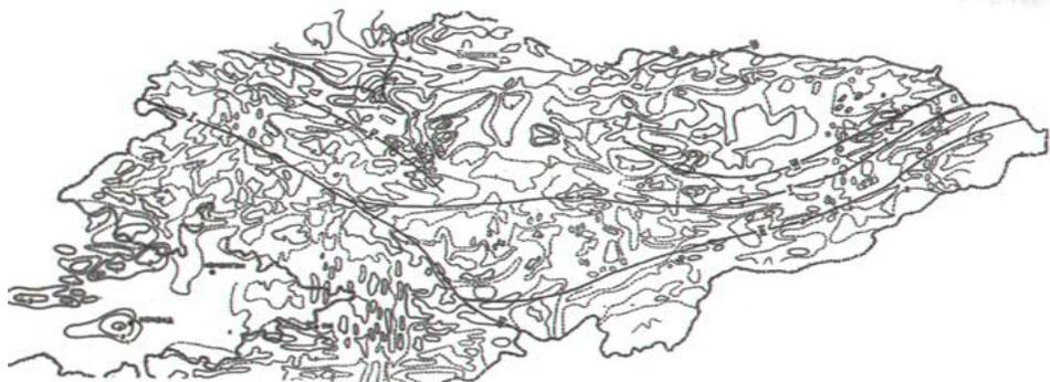
Рис.15. Карты аномального геомагнитного поля Кыргызского Тянь-Шаня для высот:  $H=60$  км;  $H=100$  км, в координатах  $\lambda = 70 - 80^{\circ}$  в.д. и  $\varphi = 39 - 40^{\circ}$  с.ш. Сплошные изолинии – положительные значения, пунктирные – отрицательные поля Т, мЭ. (Карты составлены на основе измерений спутником Земли).
