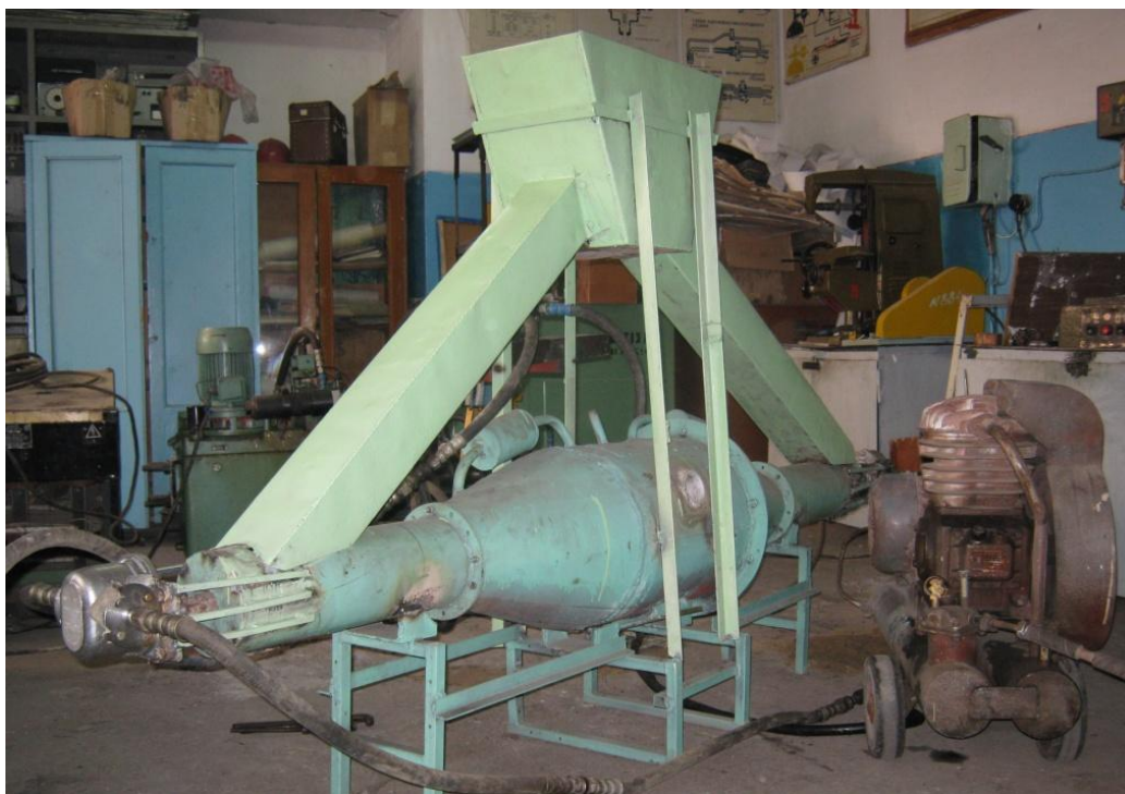
Рис. 8. Установка для скоростного непрерывного пиролиза угля
