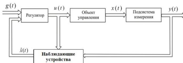
Рис. 3. Структура САУ с наблюдающим устройством.
