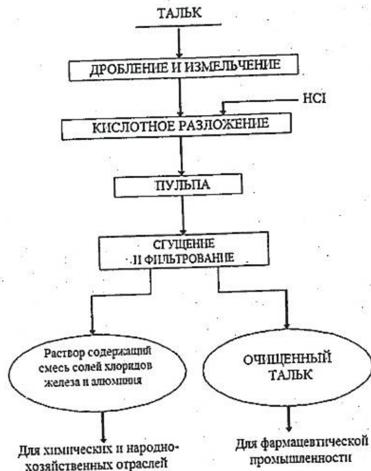
Рисунок.8. - Принципиальная технологическая схема очистки талька солянокислотным способом
