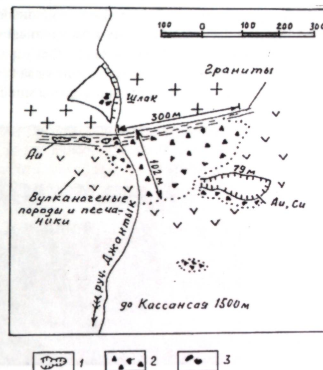
Рис. 271. Золотой рудник Джантык. 1 - карьерные выработки, 2 - отвалы пустой породы, 3 - железные шлаки
