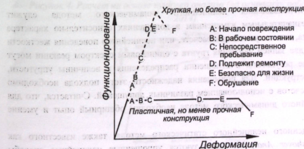
Рисунок 3. Иллюстрация возможных уровней функционирования (стойкости) для пластичных и хрупких конструкций (Руководство Международной федерации по железобетону, 2003)
