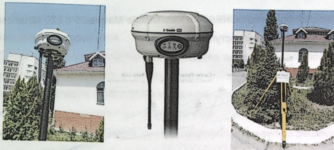
Рис. 1. Комплект оборудования для проведения GPS-съёмки с использованием RTK-режима. Съёмка производится на участке КГУСТА им. Н. Исанова.
