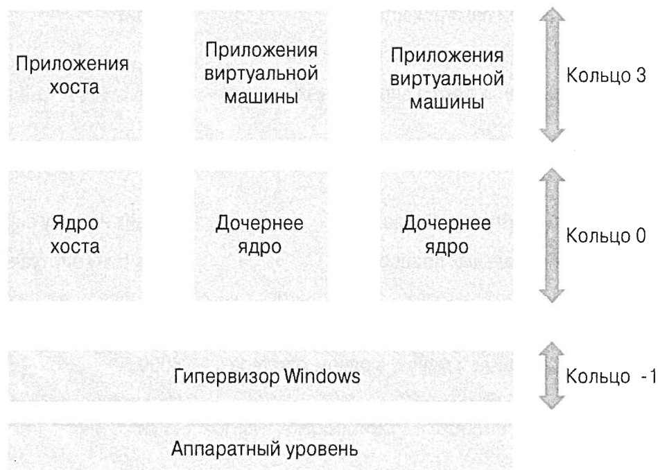
Рис. 27.8. Благодаря гипервизору хост функционирует на том же уровне, что и виртуальные машины: поверх уровня гипервизора
