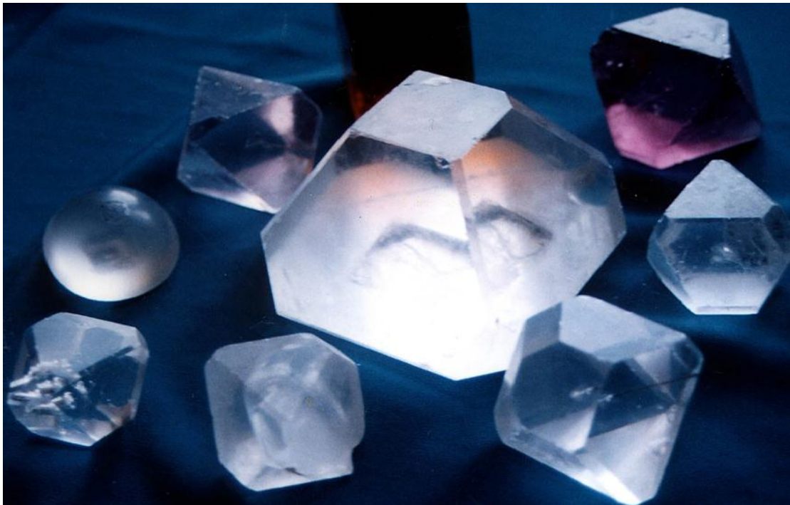
Рис.2. Искусственные щелочногаллоидные кристаллы, выращенные в лаборатории кристаллофизики
