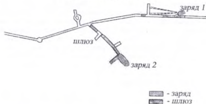
Рис. 2. Расположение зарядов в шахте для взрывов «Туя-Муюн» 1959 и 1960 гг. [2]
