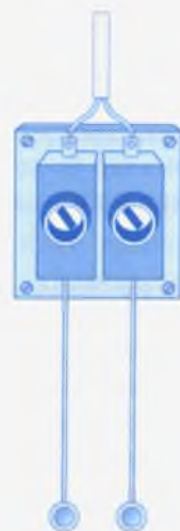
105-сүрөт. Электр сактагычын туташтыруу.
