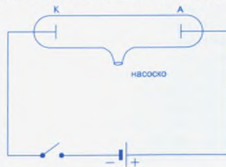
112-сүрөт. Суюлтулган газдагы өз алдынча разряддын пайда болушун байкоого арналган тажрыйба.
