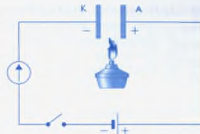
109-сүрөт. Газ аркылуу электр тогунун өтүшүн мүнөздөөчү тажрыйбанын схемасы.
