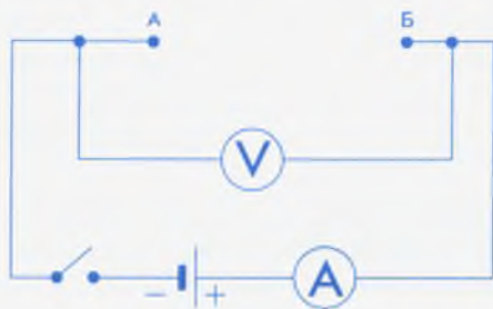
93-сүрөт. Электр каршылыгынын өткөргүчтүн узундугунан жана кесилиш аянтынан көз карандылыгын көрсөтүүчү тажрыйбанын схемасы.
