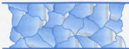
44-сүрөт. Темирдин поликристаллдык түзүлүшү.
