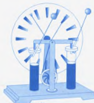
71-сүрөт. Электрофордук машина.
