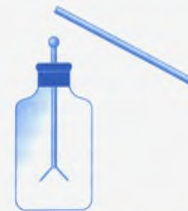
63-сүрөт. Нерселердин заряддалгандыгын электроскоп менен байкоо.
