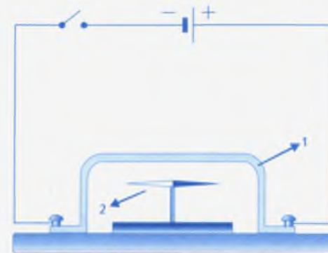
80-сүрөт. Токтун магниттик аракети көрсөтүүчү түзүлүш.
