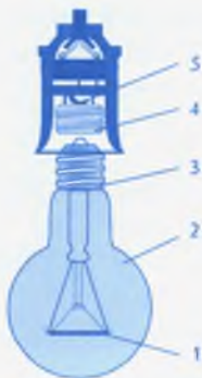
101-сүрөт. Кызыткыч электр лампасынын түзүлүшү.
