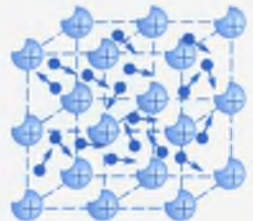
107-сүрөт. Металлдын кристаллдык торчосу.
