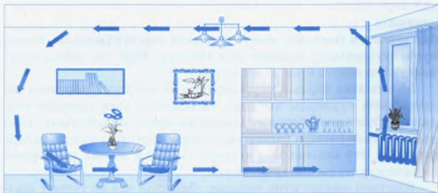
19-сүрөт. Абанын конвекциялык агымы.
