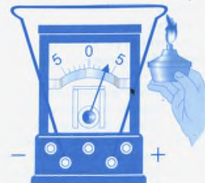
72-сүрөт. Термоэлементтин ток булагы катары көрсөтүлүшү.
