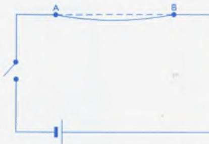
78-сүрөт. Токтун жылуулук аракети көрсөтүүчү тажрыйбанын схемасы.
