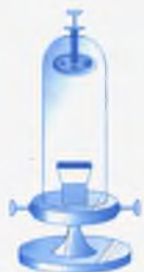
118-сүрөт. Эки электроддуу лампа.
