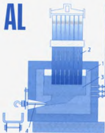
116-сүрөт. Таза алюминий өндүрүүгө арналган түзүлүш.
