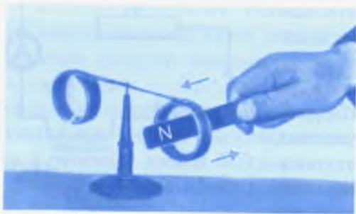
38-сүрөт. Ленц эрежесин текшерүүчү тажрыйба.
