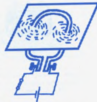
21-сүрөт. Тегерек токту магнит талаасын үйрөнүүчү түзүлүш.
