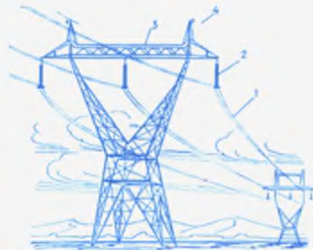
42-сүрөт. Электр берүүчү тармактын бөлүктөрү.
