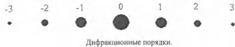
Рис. 1. Расположение дифракционных порядков в частотной плоскости при восстановлении записанного растриванного изображения с фазового носителя.
