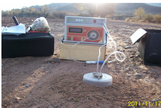
Рис. 4. Процесс измерения радона в почвенном покрове
