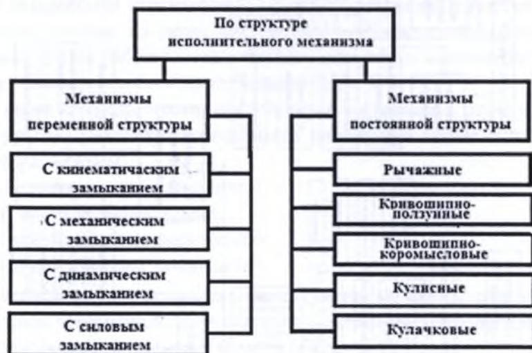
Рисунок 2 – Механические ударные механизмы по структуре исполнительного механизма
