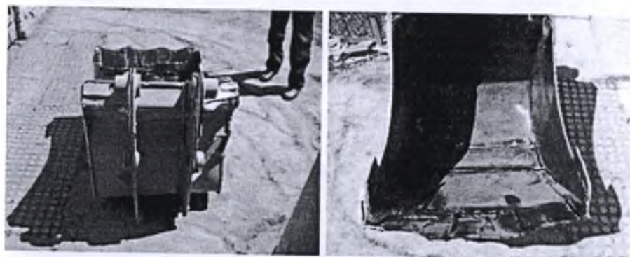
Рисунок 12 – Повреждения и разрушения, наблюдаемые в ковше в условиях эксплуатации: красные линии – зоны повреждения
