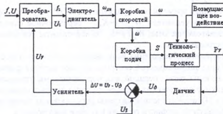
Рисунок 2 – Функциональная схема автоматической системы регулирования режимов работы токарного станка при помощи преобразователя частоты тока
