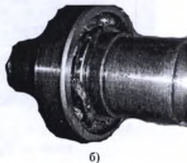
Рисунок 7 – Анализ напряжения и характерная поломка подшипника качения
