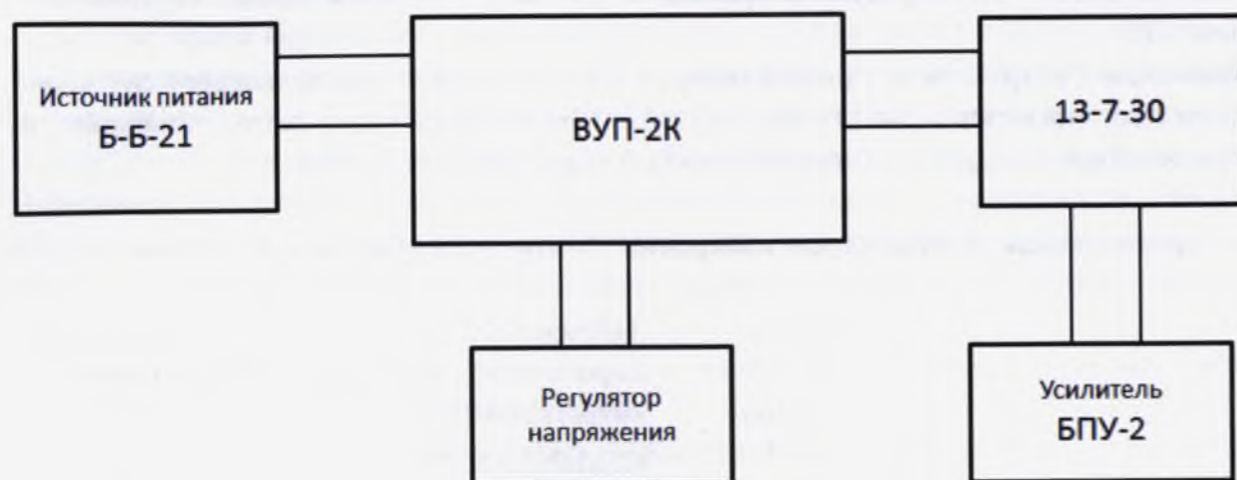
Рис.1. Общая схема комплексной установки для измерения электропроводности кристаллов
