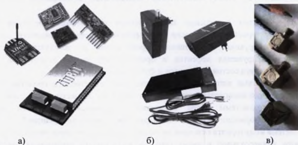
Рис. 2. Основные функциональные узлы системы мониторинга: а - ZigBee-модули; б - PLC-модемы (клиент, сервер); в - трехкомпонентные акселерометры.
