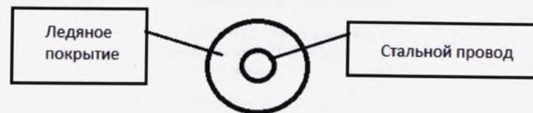
Рис. 2. Обледеневший провод (вид из торца)
