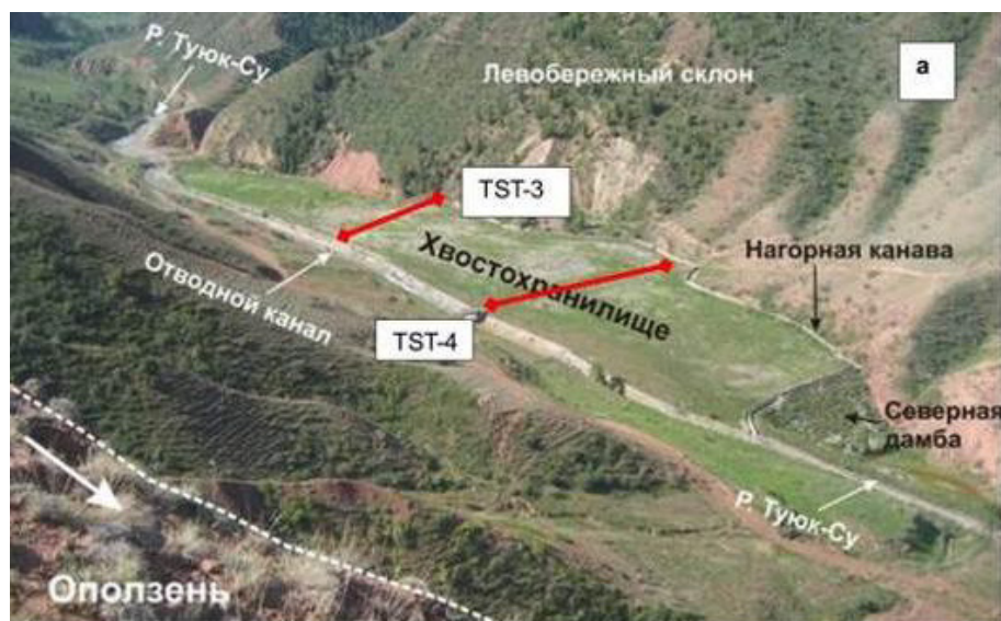
Рис.4 Электрогеотомографическая съемка двух разрезов хвостохранилища Туук-Суу с указанием мест проникновения подземных вод из канала и вследствие проникновения через тело хвостохранилища. Данные из отчета ВНИПИИПромтехнологии, 2011
