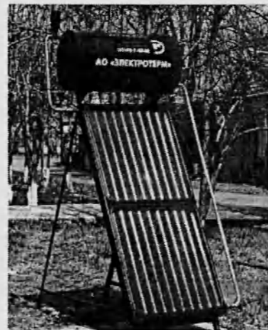
Водонагревательная установка предназначена для нагрева воды за счет использования солнечной энергии
