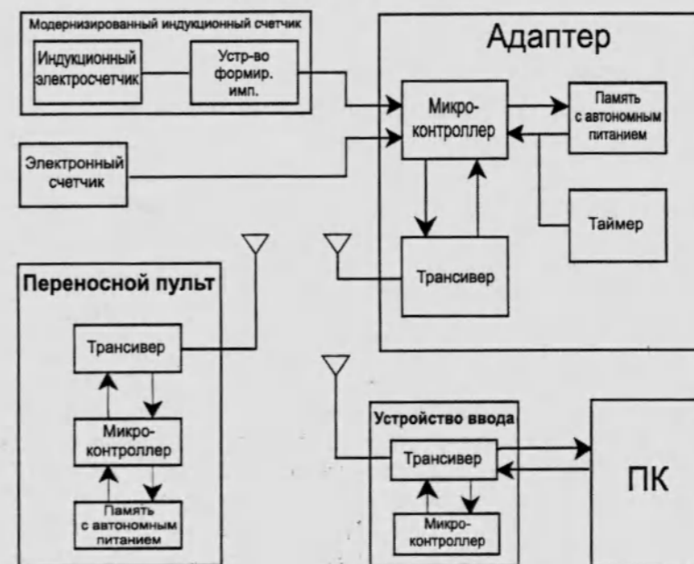
Структурная схема АСКУЭ
