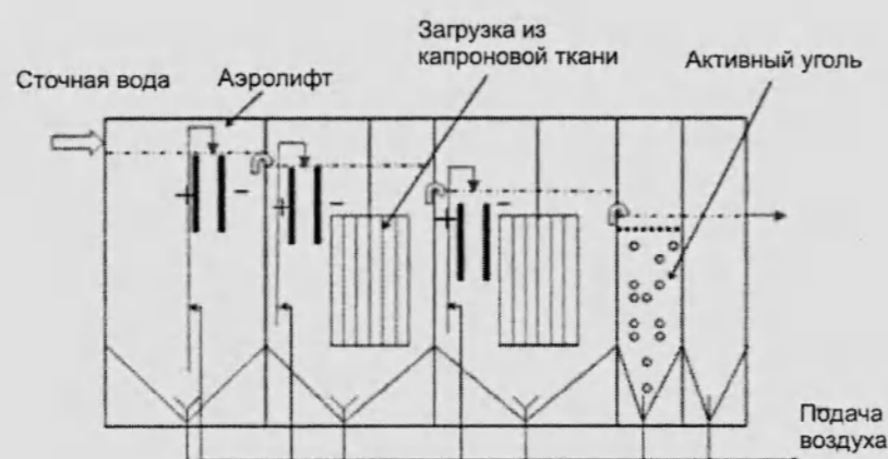
Рис. 1. Схема комплексного устройства для микробиологического разрушения цианидов
