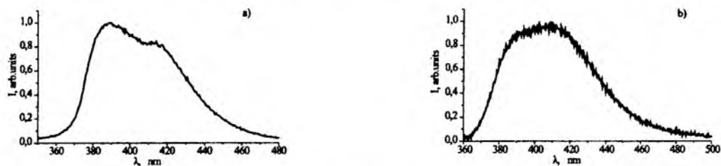
Рис. 2. Спектры рентгенолюминесценции кристалловолокон LGBO (a), LYBO_N1 (b), измеренные при T=300 К.
