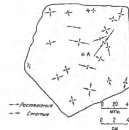
Рис. 7. Распределение остаточных напряжений в поперечном сечении базальтовой колонны [14].
