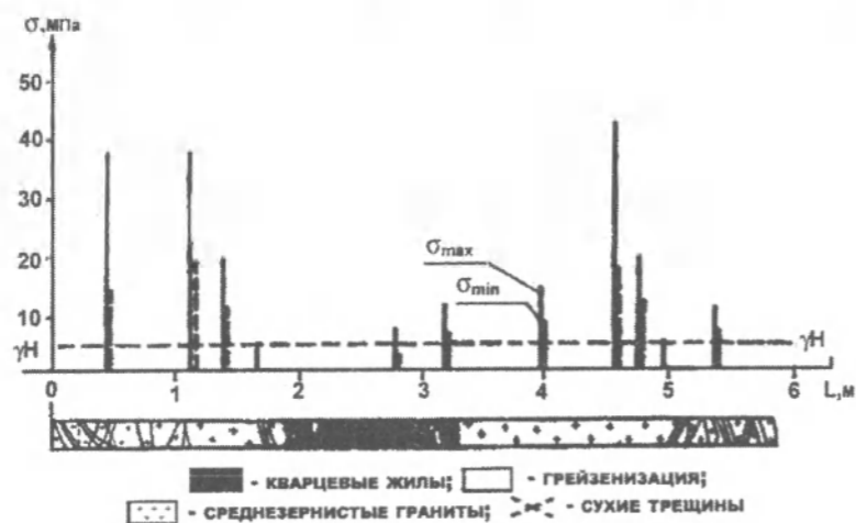
Рис. 6. Результаты измерения напряжений методом разгрузки по горизонтальной скважине на месторождении Восточный Коунрад на глубине 220 м (Центральный Казахстан) [11].
