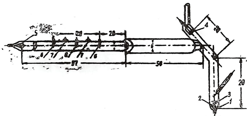
Рис. 1. Схема разрядной трубки (размеры в см): 1—жидкий ртутный катод; 2—молибденовый фиксатор; 3—игнайтер из карбида кремния; 4—дежурный анод; 5—рабочий анод; 6—цилиндрические, 7—стеночные, 8—осевой цилиндрический зонды.
