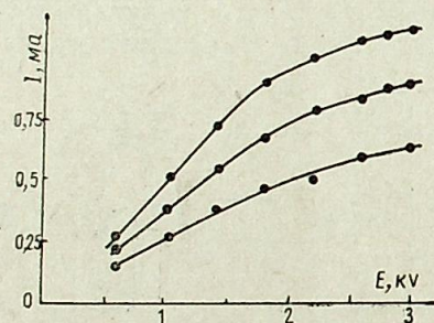
Рис. 2. Вольтамперные характеристики сульфида кадмия при различной интенсивности освещения.
