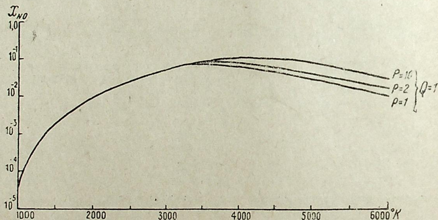
Рис. 3. Зависимость молярных долей окиси азота от температуры для Q = 1 при P = 1, 2 и 10 атм.
