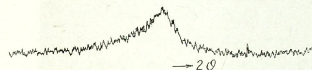
Рис. 7. Линия (200), полученная непосредственно на ленте самописца, для образца с 18% Ga, деформированного шкуркой закаленного образца.
