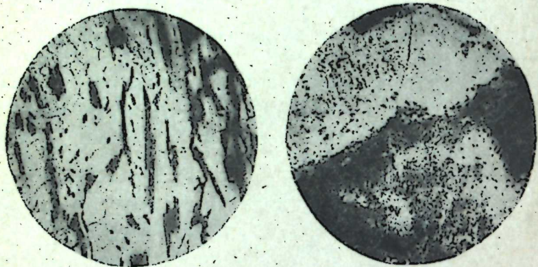
Фиг. 106. + NN. Белое — микропертит (большие таблицы) и нефелин (ср. мелкие, изометричные, округлые зерна). Черное — эгирин и щелочный амфибол. Структура панааллотриоморфнозернистая. Порфириовидный эгиринороговообманковый неф. сиенит. Текстура массивная. Образец взят сразу под уч. «3 жилы», между шт. «Салье» и шт. № 3. Обр. № 205. Шлиф № 79. \times 15 .
