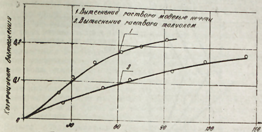
Рис. 4. Зависимость коэффициента вытеснения 10% раствора в дистиллированной воде моделью нефти от времени (температура 50°C).
