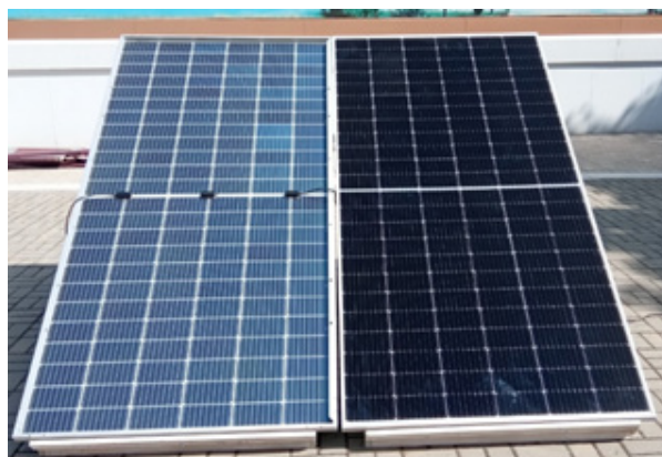
а) б) Рис. 1. Внешний вид задней (а) и передней (б) поверхностей двусторонней солнечной панели
