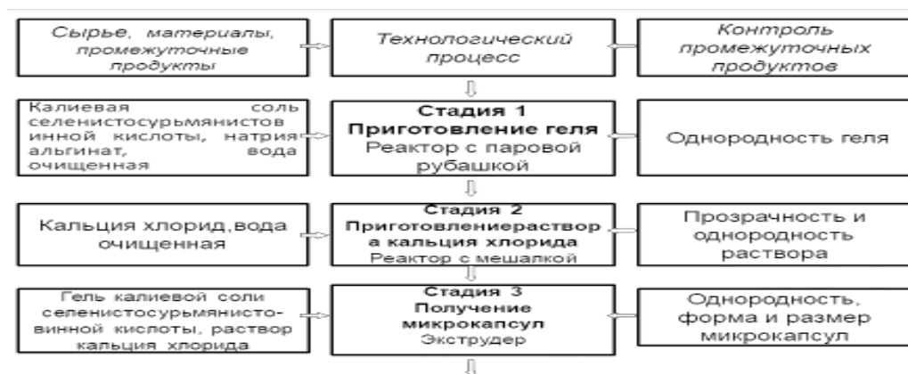
Рисунок 1. Технологическая схема производства микрокапсул селенистосурьмянистовинной кислоты
