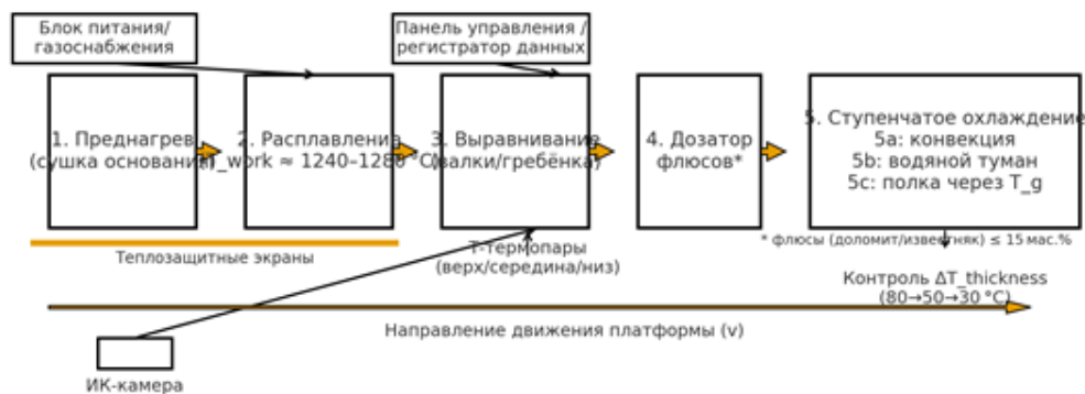
Рисунок 1. Линейно-модульная установка для in-situ термоплавки дорожного слоя. 1 — преднагрев; 2 — расплавление; 3 — выравнивание; 4 — дозатор флюсов; 5 — ступенчатое охлаждение (5а — конвекция; 5b — водяной туман; 5с — полка через T_g ); ИК-контроль и термопары обеспечивают удержание \Delta T_{thickness} 80→50→30 °С.
